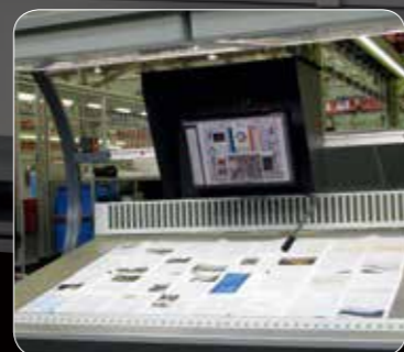
『スクロール』ソリューション：プレスシートのゾーン領域でゾーンを表示する位置センターと稼働モニター。
